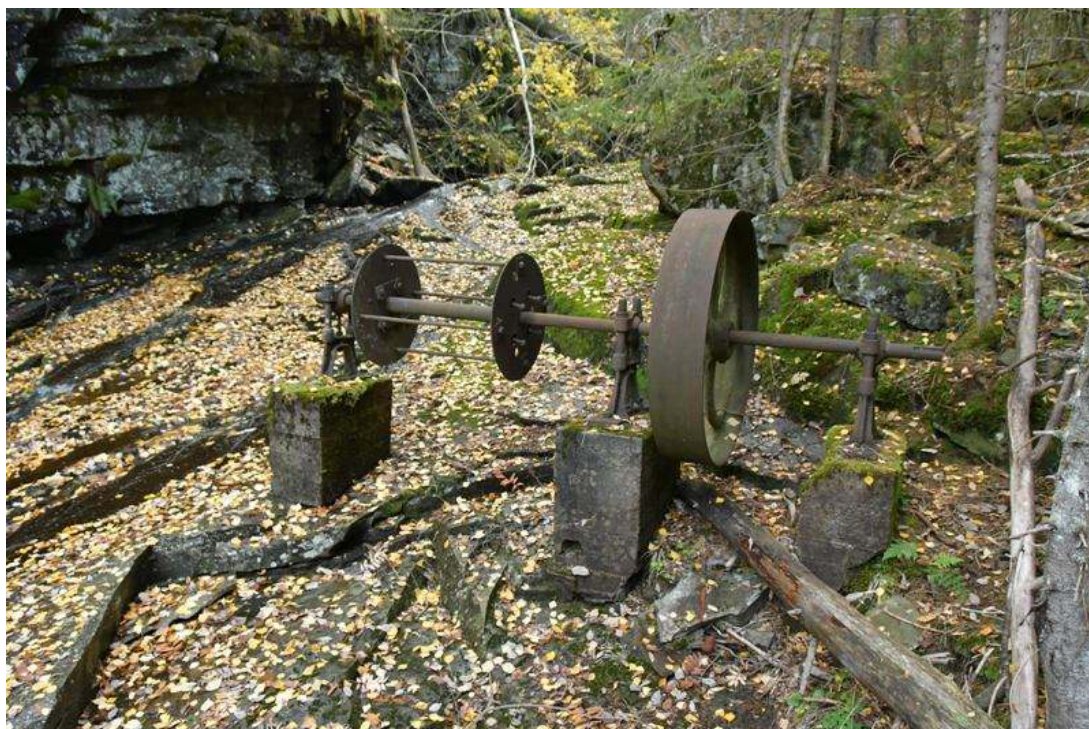
Remskive og kjerne i skovlehjulet til Urselvsagen som ble bygget og brukt under siste krig. Selve sagen stod opp til høyre ble rundt 1950 demontert og flyttet.
